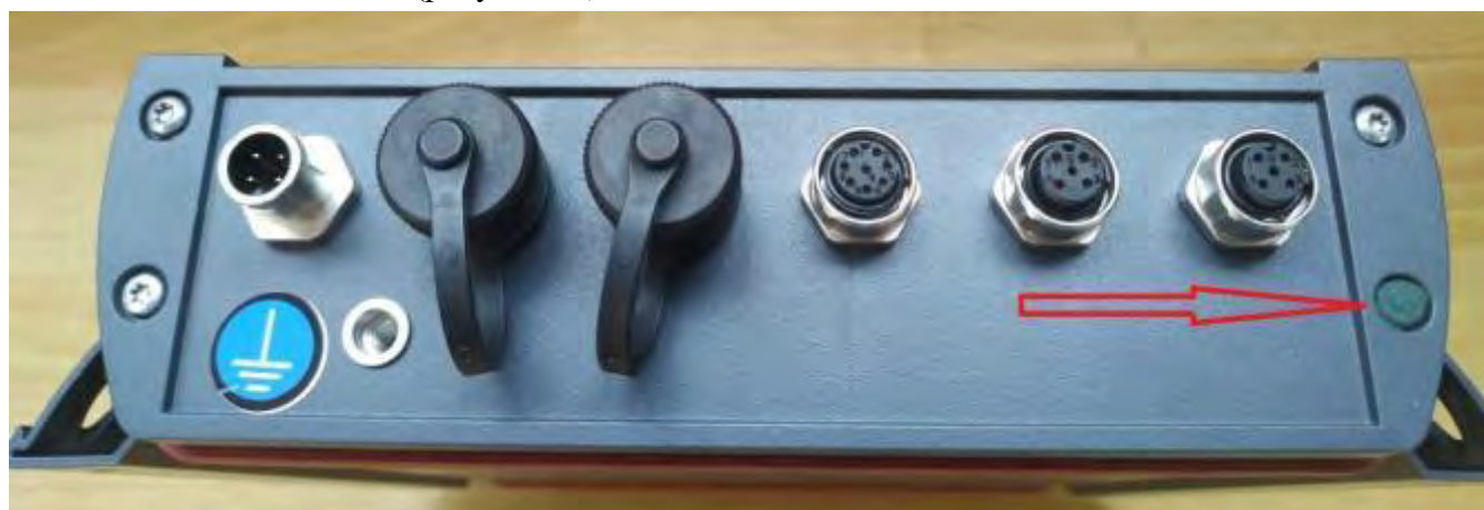
Рисунок 46. Место пломбирования ВБ
